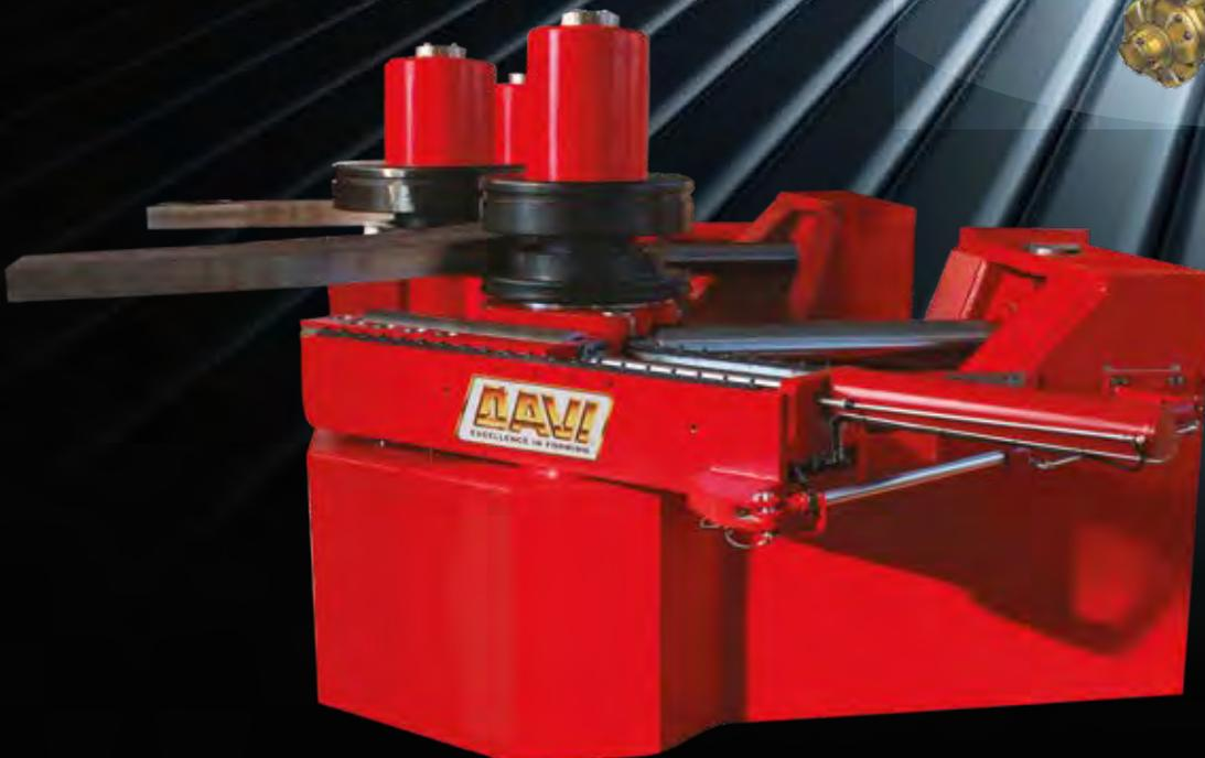
Alle Maschinen sind mit 3D Führungswalzen ausgestattet
