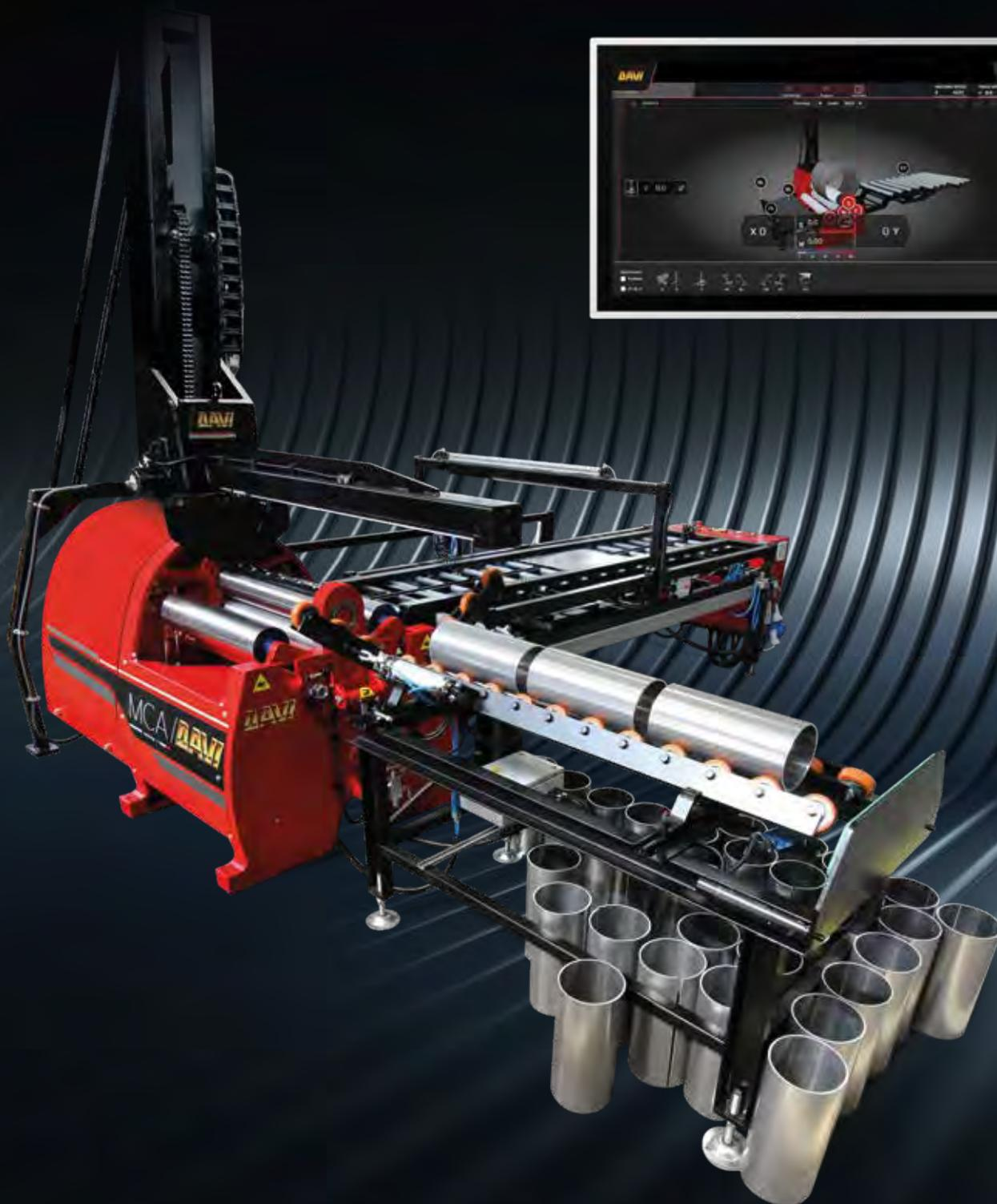
Le système de contrôle Davi, conçu pour le plus haut niveau d'automatisation possible sur le marché, offre la possibilité de générer automatiquement un programme complet en important le fichier CAO de la pièce, en rappelant les données de la pièce à partir de la base de données du réseau local par le biais d'un système basé sur un lecteur de code-barres et en utilisant le test de capacité hors ligne et le test de performance du retour à la normale.
