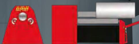
En las máquinas con guías lineales, las piezas deben inclinarse para ser sacadas debido a la construcción del marco más alto.
