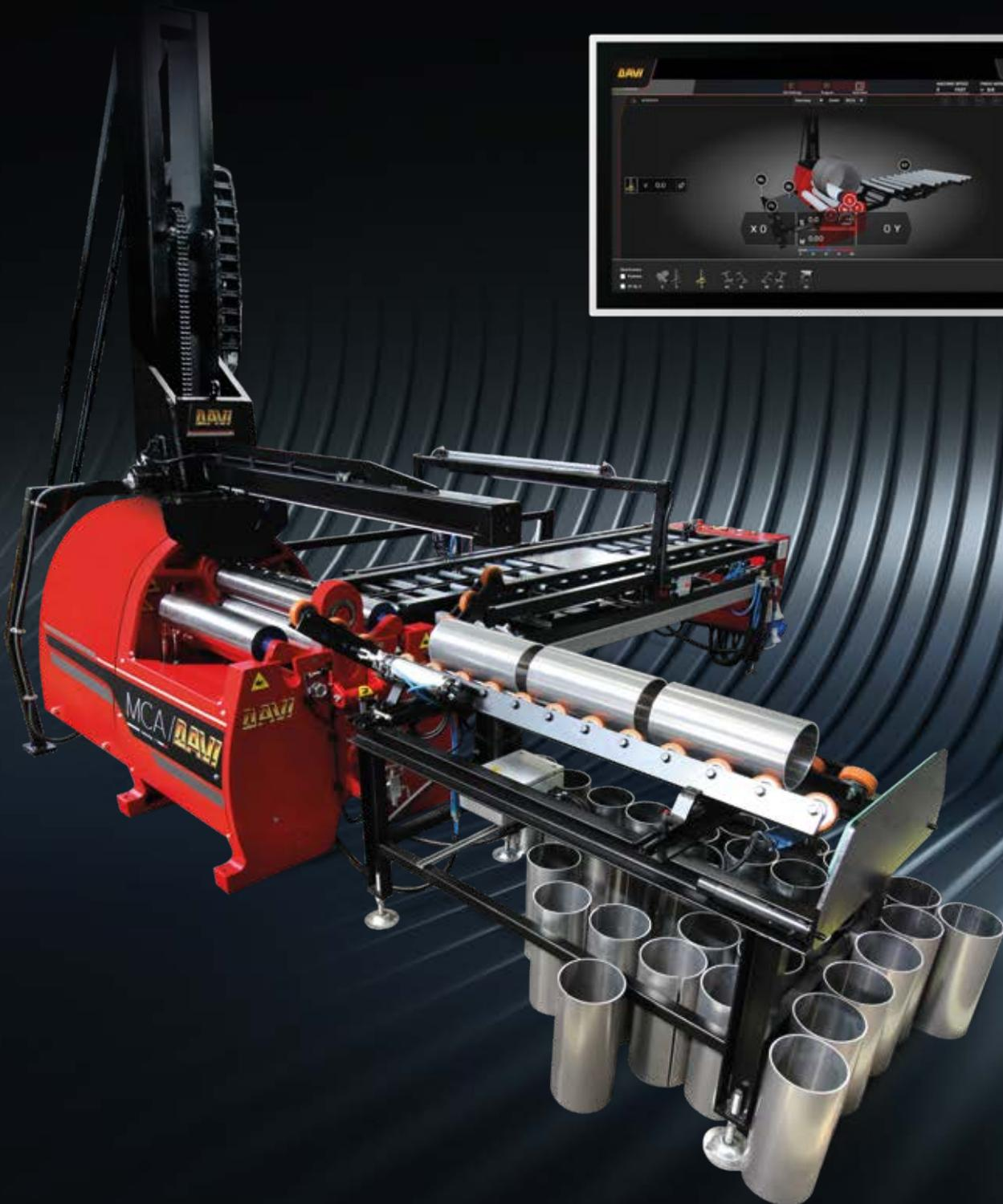
El sistema de control Davi, diseñado para ofrecer el mayor nivel de automatización posible en el mercado, ofrece la posibilidad de generar automáticamente un programa completo importando el archivo CAD de la pieza de trabajo, recuperando los datos de la pieza de la base de datos de la red local mediante un sistema basado en un lector de códigos de barras y haciendo uso de la test de capacidad (offline) y de rendimiento de limite elástico.
