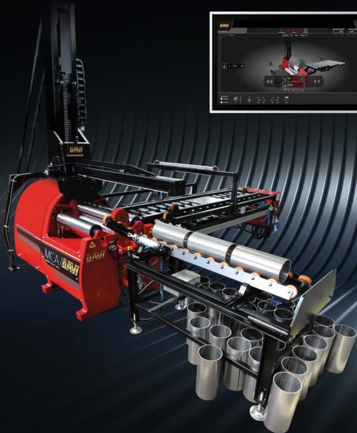
Die Davi Steuerung, die auf dem höchstmöglichen Automatisierungsgrad auf dem Markt zugeschnitten ist, bietet die Möglichkeit, automatisch ein vollständiges Programm zu generieren, indem die Werkstück-CAD-Datei importiert, Werkstückdaten aus der lokalen Netzwerkdatenbank über ein auf Barcodeleser basierendes System abgerufen und Offline-Kapazitäts- und Rückfederungsleistungstests verwendet werden.
